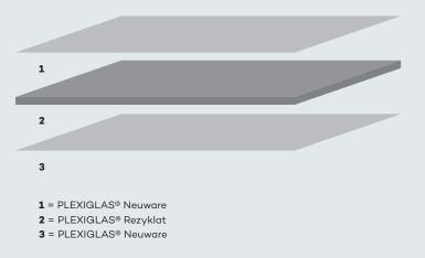
PLEXIGLAS<sup>®</sup> proTerra Massivplatte mit zwei Coextrusionsschichten
